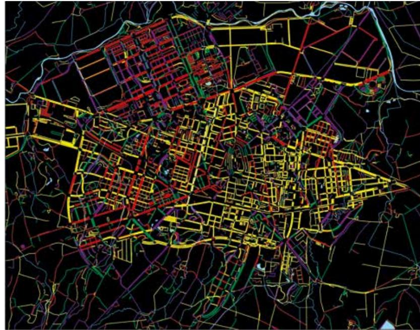
Vitoria-Gasteiz, carte du maillage du réseau viaire réalisée par Bfluid, en utilisant différentes couleurs pour refléter le degré d'alignement des trames (cf. encadré p. 25) © Bfluid 2017
